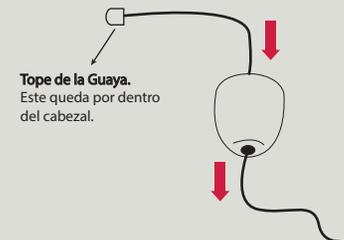
**5** Asegure el cabezal enroscándolo en cada uno de los pines que la luminaria trae en su parte posterior.
