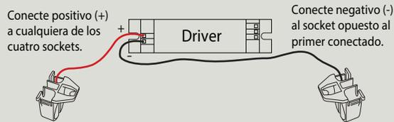
**3** Realice los puentes de conexión entre los sockets del primer tubo a los sockets del segundo tubo. De la siguiente manera:
