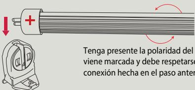
Tenga presente la polaridad del tubo, esta viene marcada y debe respetarse según la conexión hecha en el paso anterior.
