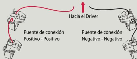
**4** Coloque los tubos alineando las terminales de los extremos con la entrada de los sockets asegurados. Luego gire los tubos para garantizar su conexión.
