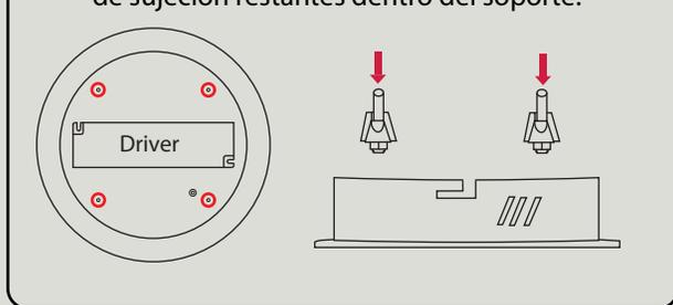
**6** Instale la Guaya en los pernos restantes y ajuste la altura de la Luminaria a conveniencia, o siguiendo indicaciones del diseño.
