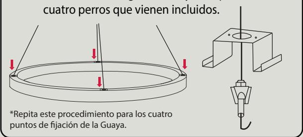
\*Repita este procedimiento para los cuatro puntos de fijación de la Guaya.
