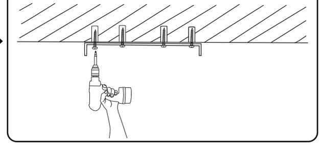
**4** Inserte la Guaya por la perforación central de las cuatro platinas ubicadas en la parte posterior de la Luminaria. Asegure la Guaya a la platina con los cuatro pernos que vienen incluidos.
