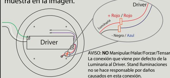
**7** Conecte los cables de alimentación a la Red. Conecte correctamente los cables de línea "L", Neutro "N" y Tierra.
