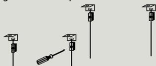
**5** Tome la parte inferior de la guaya e insértela a través de las perforaciones de la parte posterior de la luminaria.
