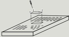
1 Tome una de las prensaestopas e insertela en el chasis como se muestra en el siguiente paso:
