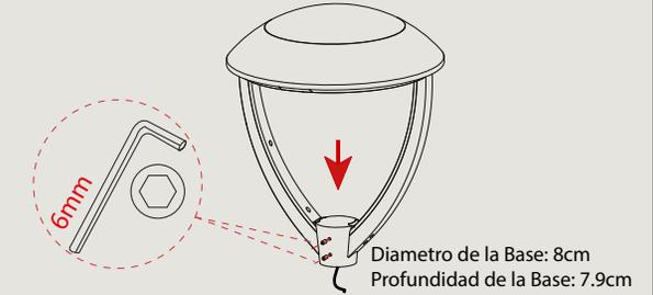
**9** Realice la conexión de la luminaria a la Red de alimentación. Conecte correctamente los cables de Línea "L", Neutro "N" y Tierra.
